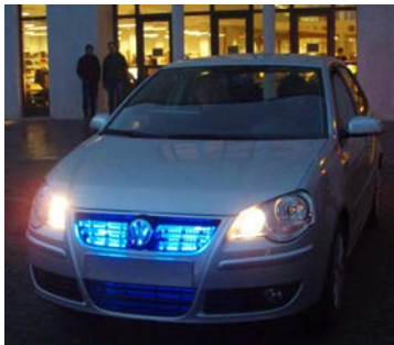
Automóvil VW Polo bicomcombustible gasolina-hidrógeno
